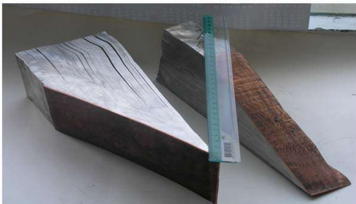
Рис. 3. Фото фрагмента алюминиевой ошинки, сваренной взрывом (количество гибких полос – 74 шт.)
