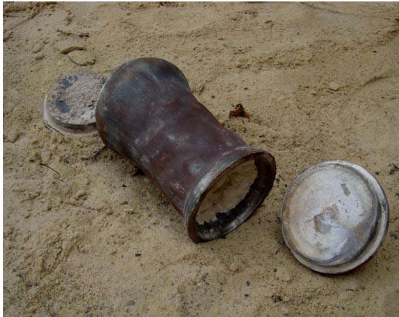
Рис. 5 Разрушенная пресс-форма (величина удельного импульса 0,22 МПа·с)
