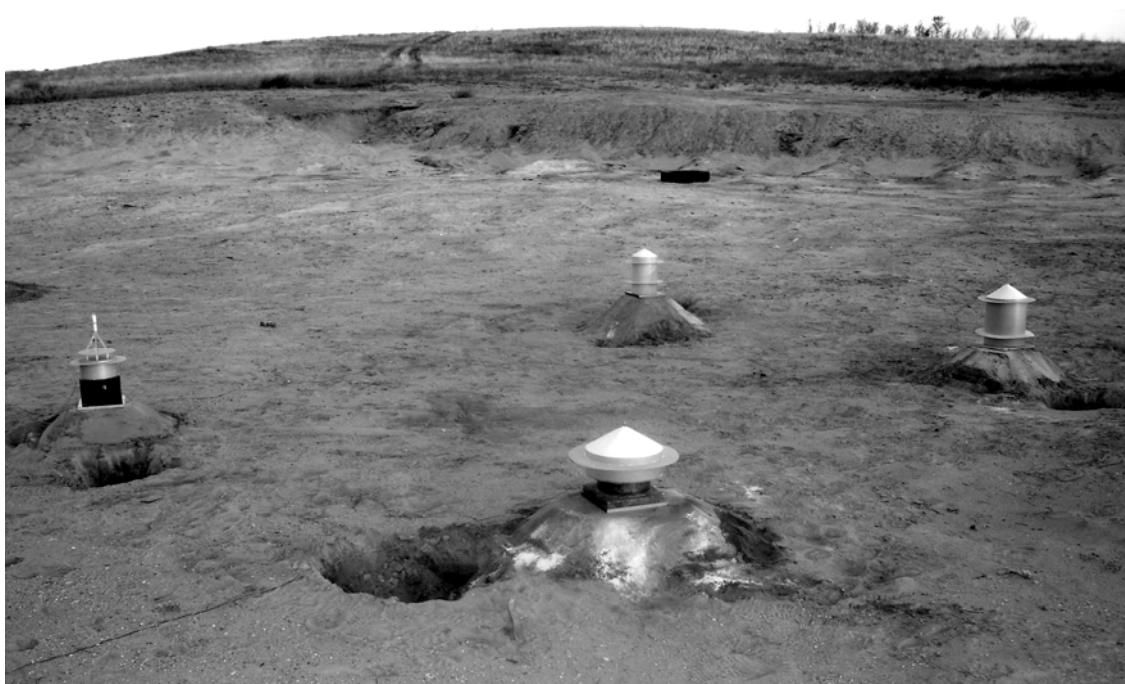
Рис. 1. Пресс-формы, снаряженные зарядом ВВ, серии экспериментов ударно- волновой обработки силикат-глыбы
