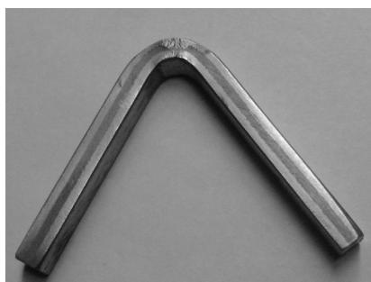
Рис.2 Образец трехслойного материала, угол 120^\circ \pm 3^\circ
