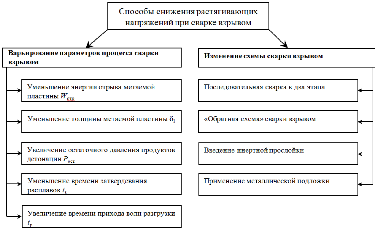
Рис. 4. Способы снижения растягивающих напряжений при сварке взрывом
