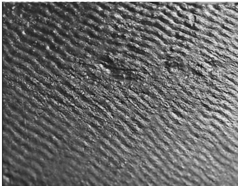
Рис. 12. Внешний вид поверхности трехслойного медно-стального композита, полученного по батарейной схеме сварки взрывом ( \delta_2 = 2 мм)
