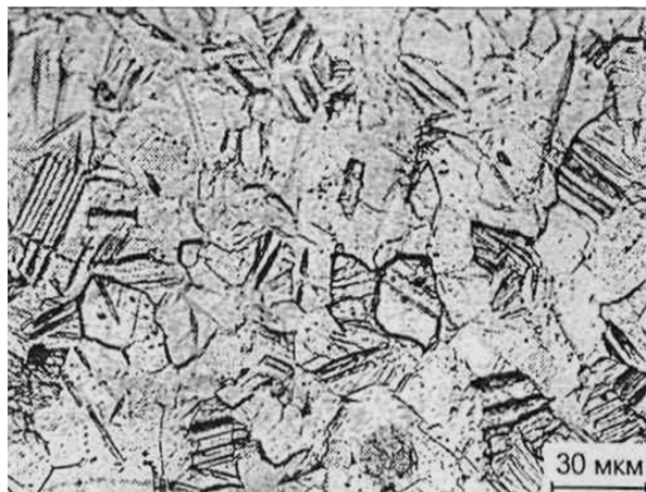
Рис. 1. Структура образца из титана после ударного нагружения [7]
