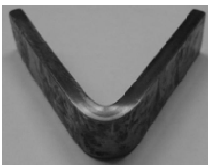
Рис.2 Образец трехслойного материала, угол 120^\circ \pm 3^\circ
