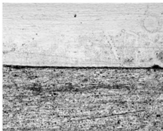
Рис. 3. Микроструктура зоны соединения медно-алюминиевого композита (см. рис. 2, зона 1) ( \times 200 )
