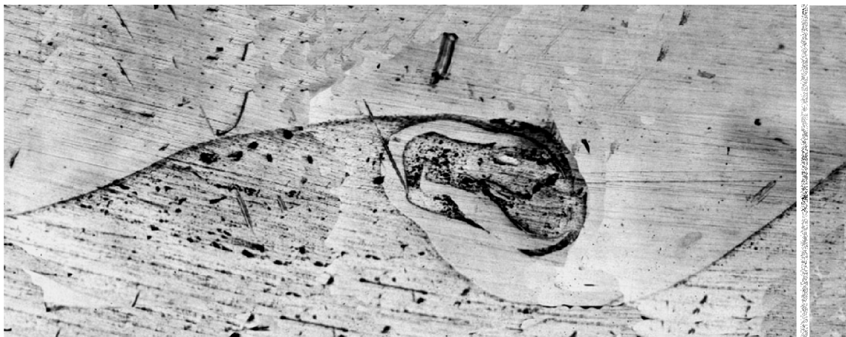
Рис. 5. Микроструктура зоны соединения медно-алюминиевого композита (см. рис. 2, зона 3) ( \times 200 )
