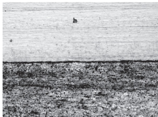
Рис. 2. Микроструктура зоны соединения медно-алюминиевого композита (см. рис. 1, зона 1) ( \times 200 )
