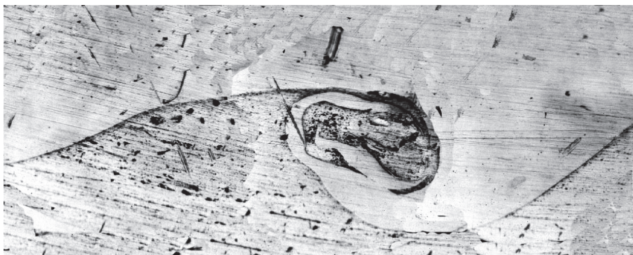
Рис. 4. Микроструктура зоны соединения медно-алюминиевого композита (см. рис. 1, зона 3) ( \times 200 ):
