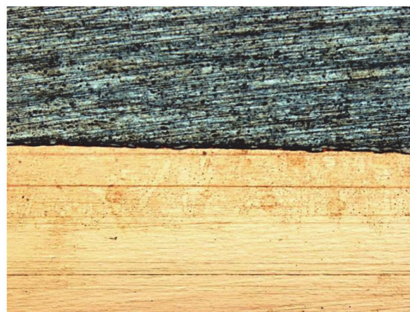
Рис. 13. Микроструктура зоны соединения медно-алюминиевого композита, полученного по батарейной схеме сварки взрывом ( \delta_{Cu} = 10 мм), \times 100
