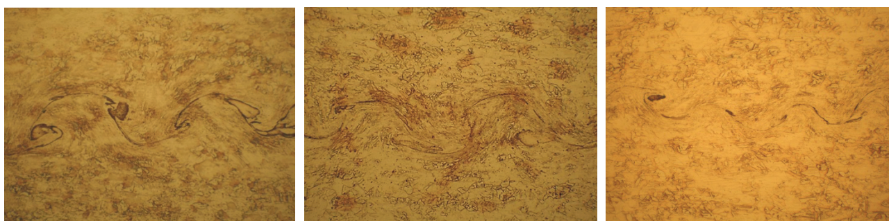
а) б) в) Рис. 4. Микроструктура сваренных взрывом медных пластин ( \times 200 ):
