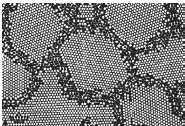
Рис. 1. Смоделированная с использованием потенциала Морзе модель атомной структуры нанокристаллического материала [6]: (чёрным обозначены атомы в зернограничных областях)
