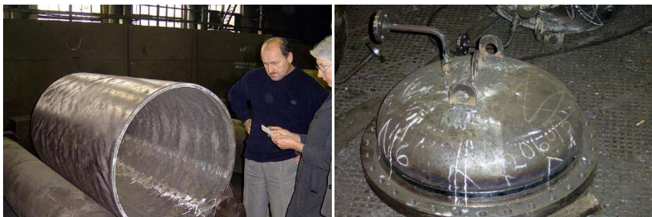
Рис. 11. Биметаллический лист после проведения испытаний на сплошность с помощью УЗД по сетке 200×200 мм
