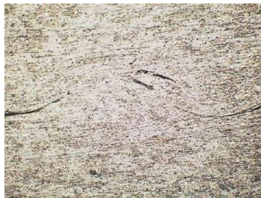
Рис. 4. Влияние амплитуды \xi УЗ колебаний на микроструктуру сваренных взрывом алюминиевых соединений ( \times 100 )
