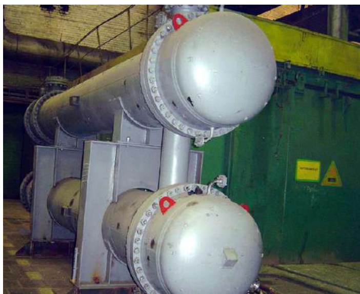
Рис. 13. Биметаллический корпус (а) одно- (б) и двухсекционного (в) холодильника газоконденсатного оборудования (ОАО «Волгограднефтемаш»)
