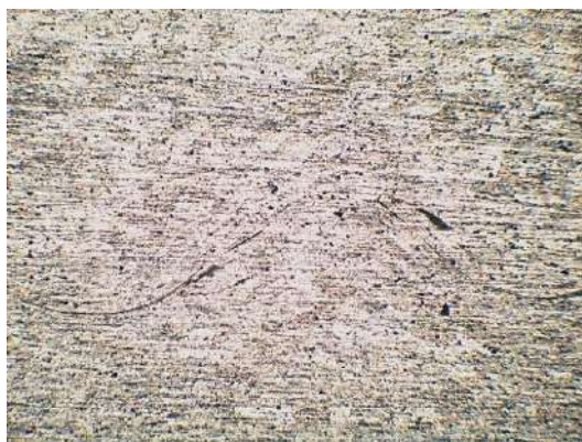
Рис. 4. Влияние амплитуды \xi УЗ колебаний на микроструктуру сваренных взрывом алюминиевых соединений ( \times 100 )
