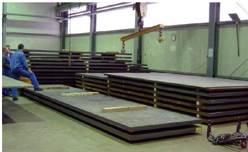
Рис. 10. Сваренный взрывом крупногабаритный коррозионно-стойкий биметалл (двухслойная сталь)
