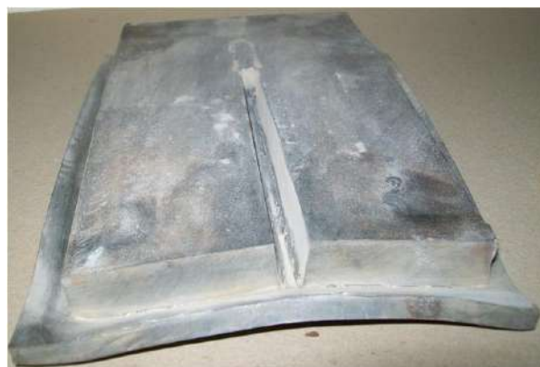
Рис. 2 Внешний вид сваренной взрывом заготовки с прямым пазом шириной 10 мм в неподвижной пластине.
