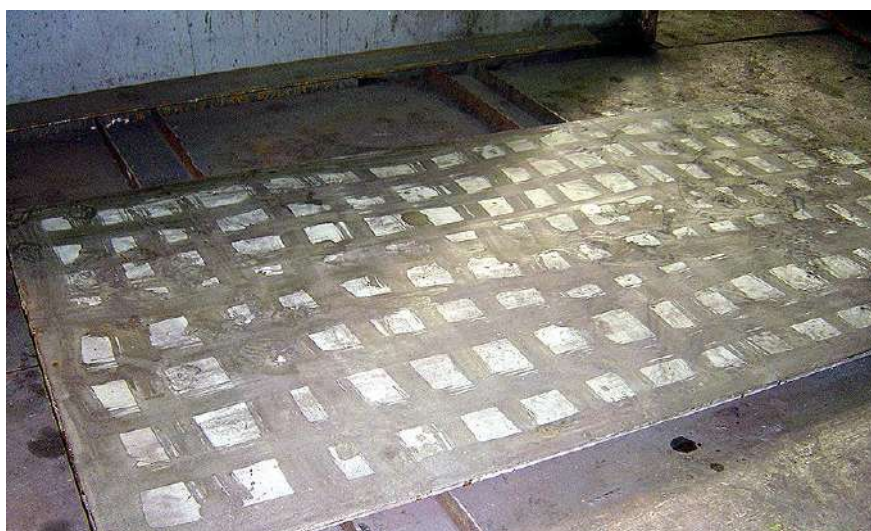
Рис. 11. Биметаллический лист после проведения испытаний на сплошность с помощью УЗД по сетке 200×200 мм
