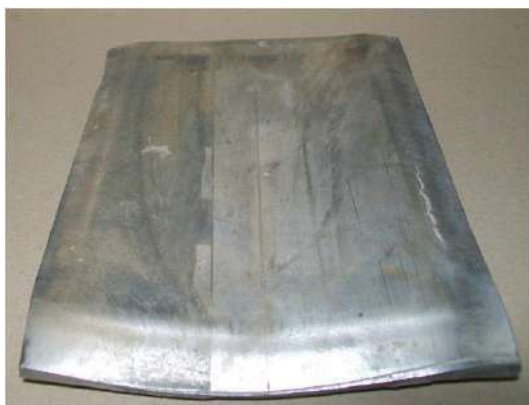
Рис. 2 Внешний вид сваренной взрывом заготовки с прямым пазом шириной 10 мм в неподвижной пластине.
