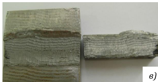
Рис. 3. Разрушение образцов после сварки:
