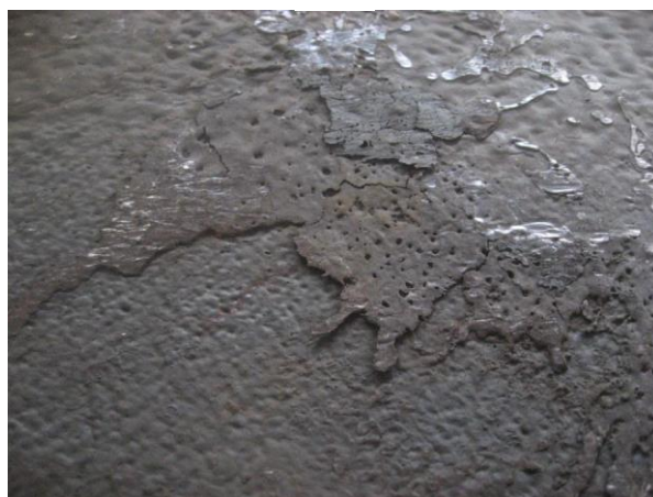
Рис. 1. Схема отбора темплетов и карта ультразвукового контроля двухслойного листа после сварки взрывом: дефекты сплошности закрашены темным (а); поверхность основного слоя в зоне несплошности после её вскрытия (б)
