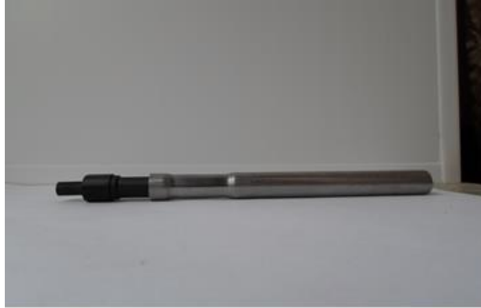
Рис. 3. Конструкция системы труба – заряд ВВ
