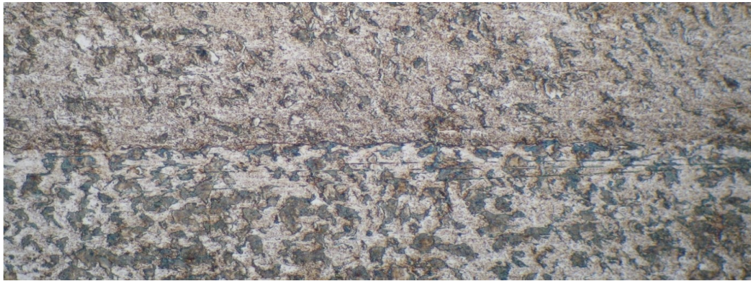
Рис. 4. Зона соединения сваренных взрывом стальных образцов с увеличенным временем действия давления продуктов детонации
