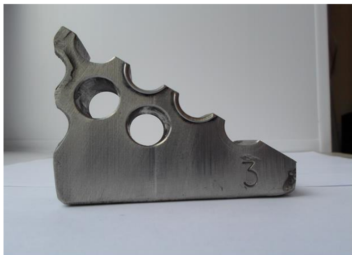
Рис. 4. Фрагмент трубной решетки, полученный при использовании заряда ЭмВВ диаметром 11 мм
