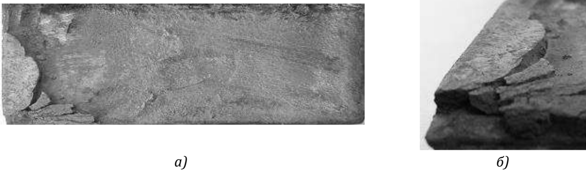
Рис. 5. Проявление «сноса» покрытий из твердых сплавов карбида хрома с титаном при скользящем нагружении:
