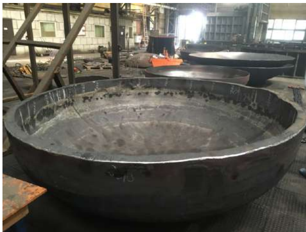
Рис. 1. Биметаллические днища после штамповки в ООО "Зенитхиммаш"
