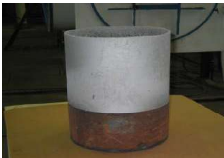
Рис. 2. Результат плазменной очистки деталей
