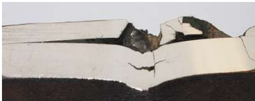
Рис. 4. Образцы после испытаний на изгиб
