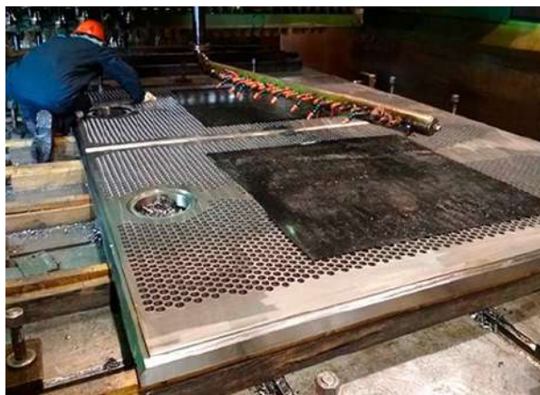
Рис. 2. Изготовление трубной решетки конденсатора АЭС "Руппур" из биметаллической плиты 09Г2С+ ВТ1-0 размерами 60(55+5)х2600х3406 мм
