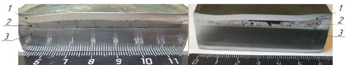
Рис. 2. Композиционный материал: слева образец № 1; справа образец № 3; 1 – верхний слой, 2 – интерметаллидный слой, 3 – нижний слой
