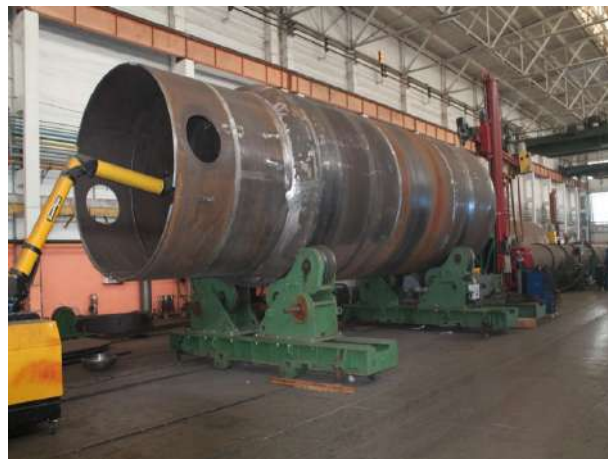
Рис. 2. Биметаллические обечайки в процессе изготовления емкостей САОЗ в АО "Моршанскхиммаш"
