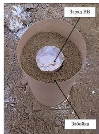
Рис. 2. Сборка исходных элементов для сварки взрывом: а – схема сборки; б – сборка на полигоне
