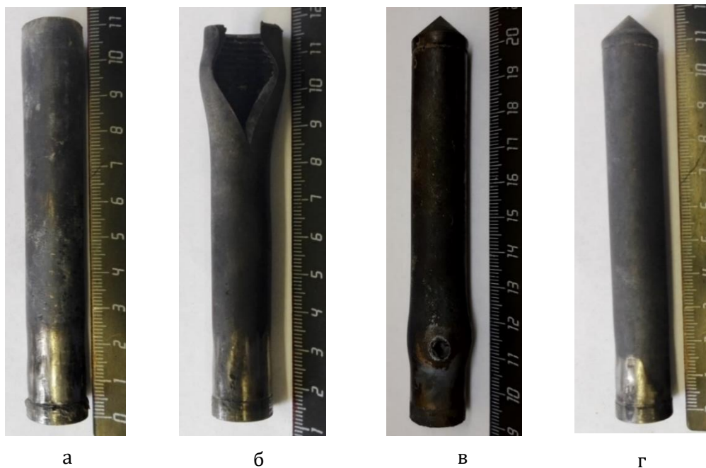
Рис. 4. Внешний вид ампул после ударно-волнового нагружения: а – 5% Al; б – 10% Al; в – 20% Al; г – 30% Al
