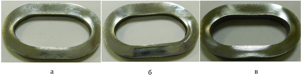
Рис. 7. Внешний вид образцов биметаллических трубных заготовок после испытаний на сплющивание до 5-кратной толщины стенки:
