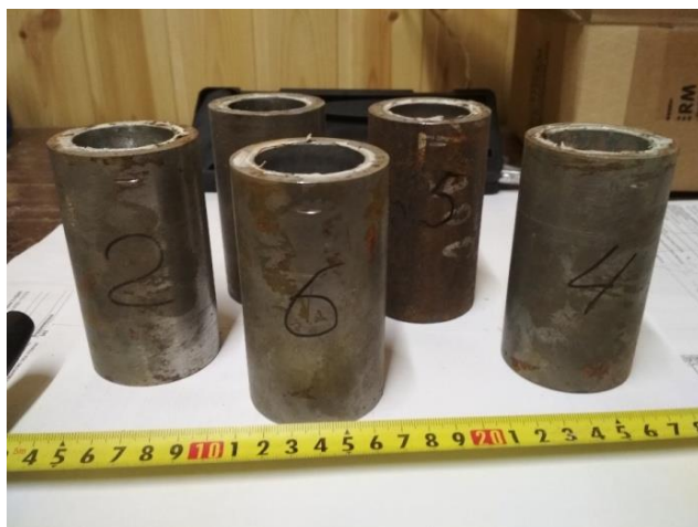
Рис. 2. Образцы труб после прессования взрывом (ПВ)
